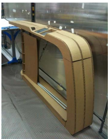
Рис. 3.24. Картонная модель автомата паспортного контроля 29 для отработки алгоритма прохождения, расположения видеокамеры, освещения и других факторов, влияющих на интуитивное
