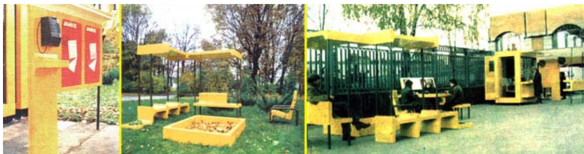
Рис.3.27. В результате было спроектировано 5 унифицированных модульных элементов, позволяющих собирать широкий диапазон уличных предметов от песочницы и скамейки до киоска и автобусной остановки. Было предложено использовать очень дешевые материалы, получаемые из вторсырья, при этом достаточно прочные и износостойкие.
